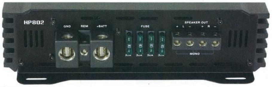
Tanta potenza uguale tanta corrente. Un'equazione indiscutibile che determina una dimensione da record dei morsetti di alimentazione. Ed una schiera proporzionata di fusibili.
